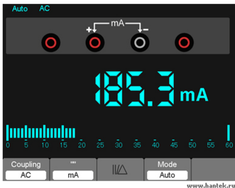
Рисунок 7-10. Измерение силы переменного тока до 600мА.
