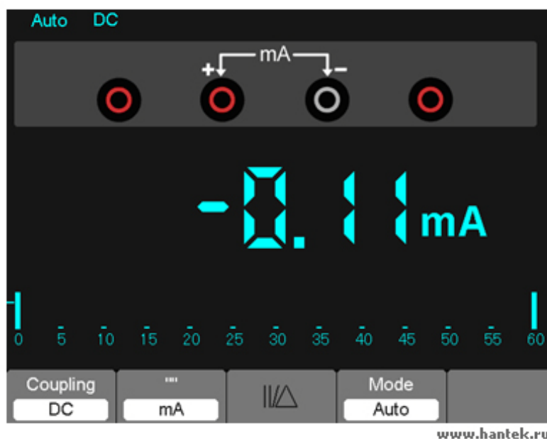
Рисунок 7-8. Измерение силы постоянного тока до 600мА.
