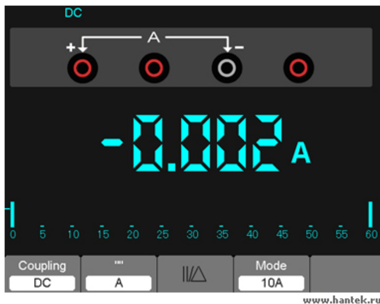
Рисунок 7-9. Измерение силы постоянного тока для 10A
