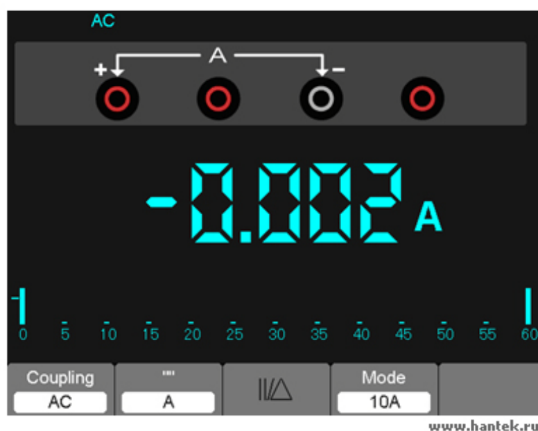
Рисунок 7-11. Измерение силы переменного тока для 10А.
