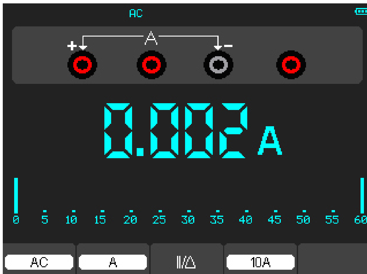
Рисунок 4-11. Измерение переменного тока (AC) до 10А
