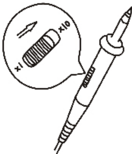
Рисунок 1-5. Установка переключателя ослабления
