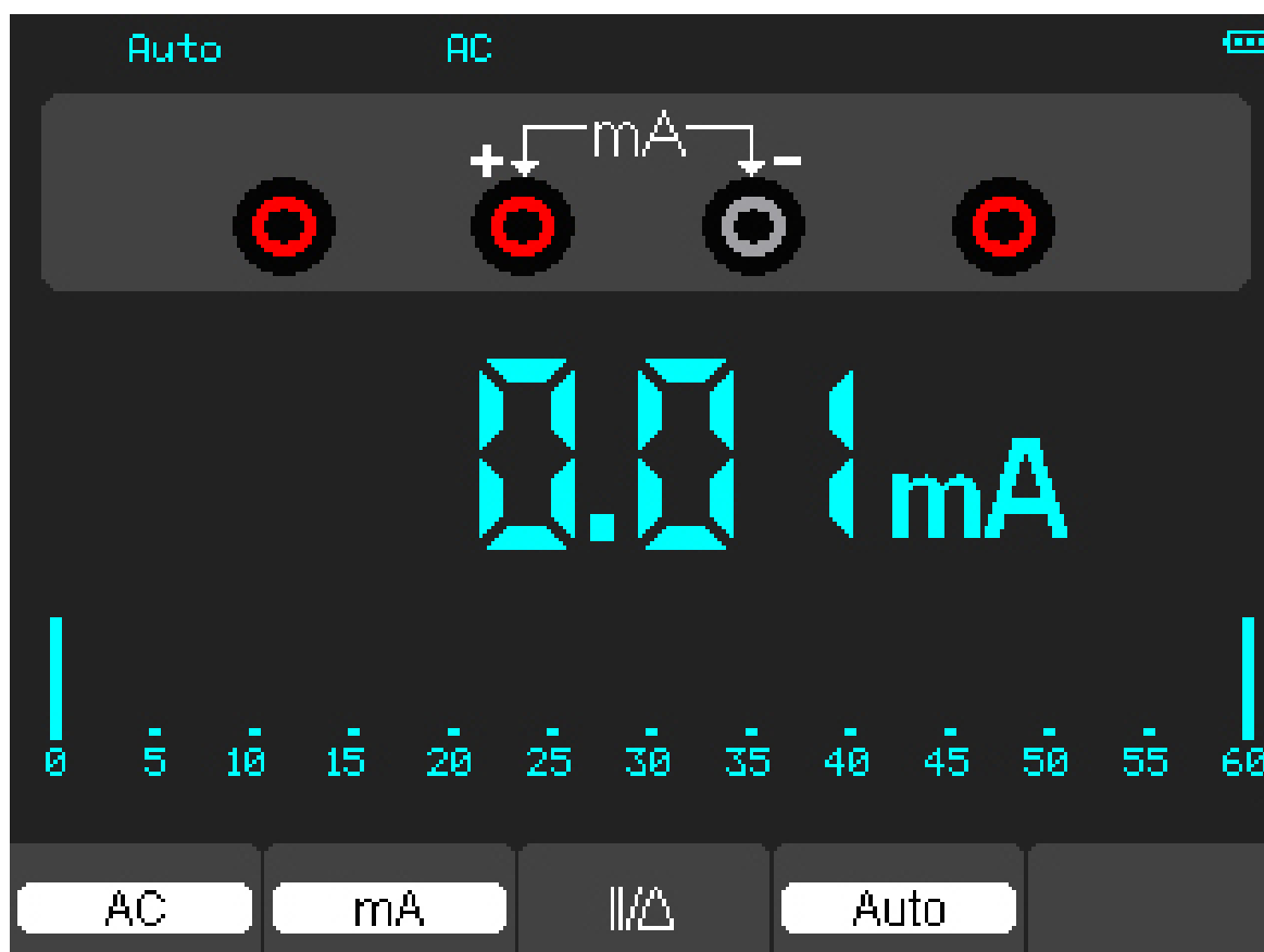
Рисунок 4-10. Измерение переменного тока (AC) до 600мА
