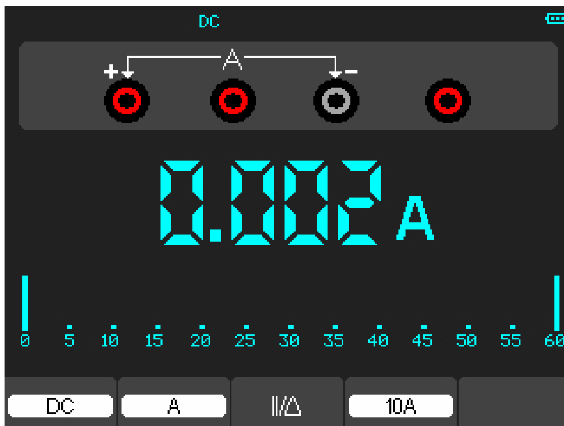
Рисунок 4-9. Измерение постоянного тока (DC) до 10А
