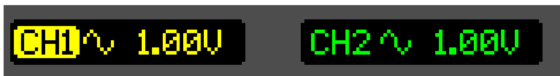
Рисунок 2-2. Канал Volt/DIV (вольт/деление)
