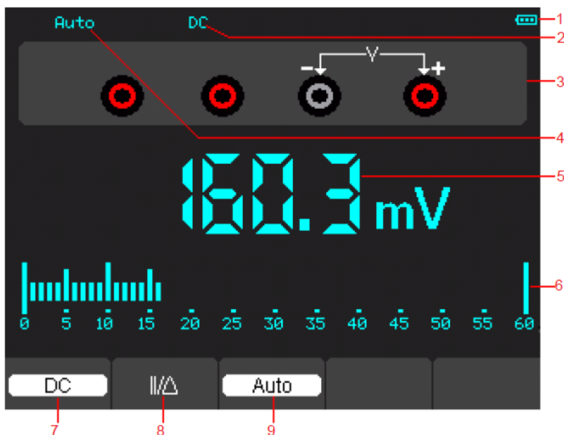
Рисунок 4-1. Рабочее окно мультиметра.
