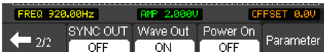
Рисунок 5-5. Меню генератора сигнала.
