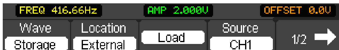
Рисунок 5-22. Меню генератора сигнала.
