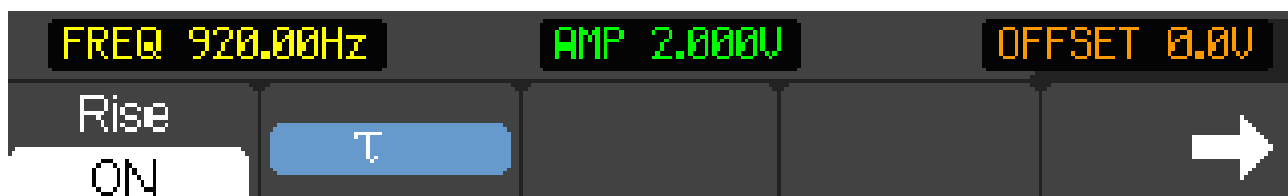
Рисунок 5-16. Меню генератора сигнала.
