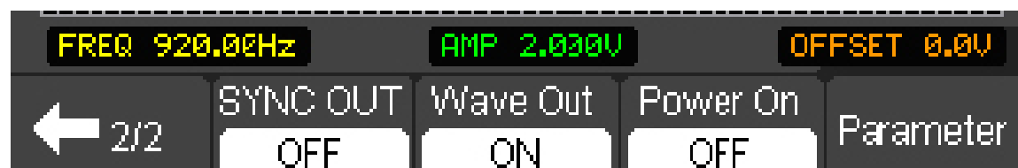
Рисунок 5-8. Меню генератора сигнала.
