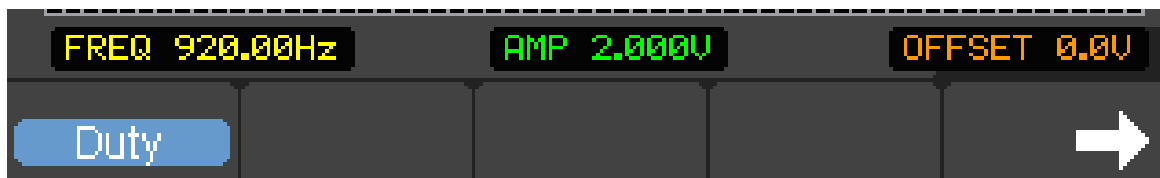
Рисунок 5-6. Меню генератора сигнала.
