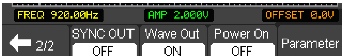
Рисунок 5-15. Окно генератора сигнала.
