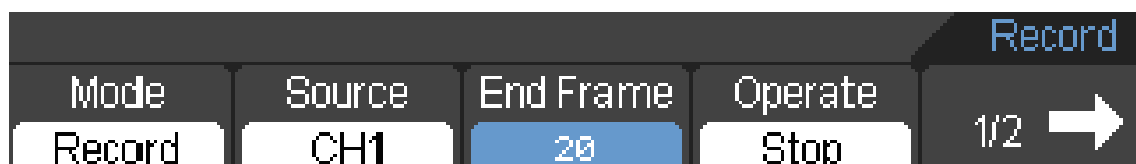
Рисунок 2-48. Меню устройства записи. (Режим Record)
