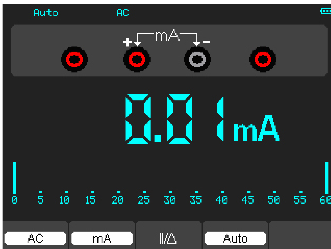
Рисунок 4-10. Измерение переменного тока (AC) до 600мА
