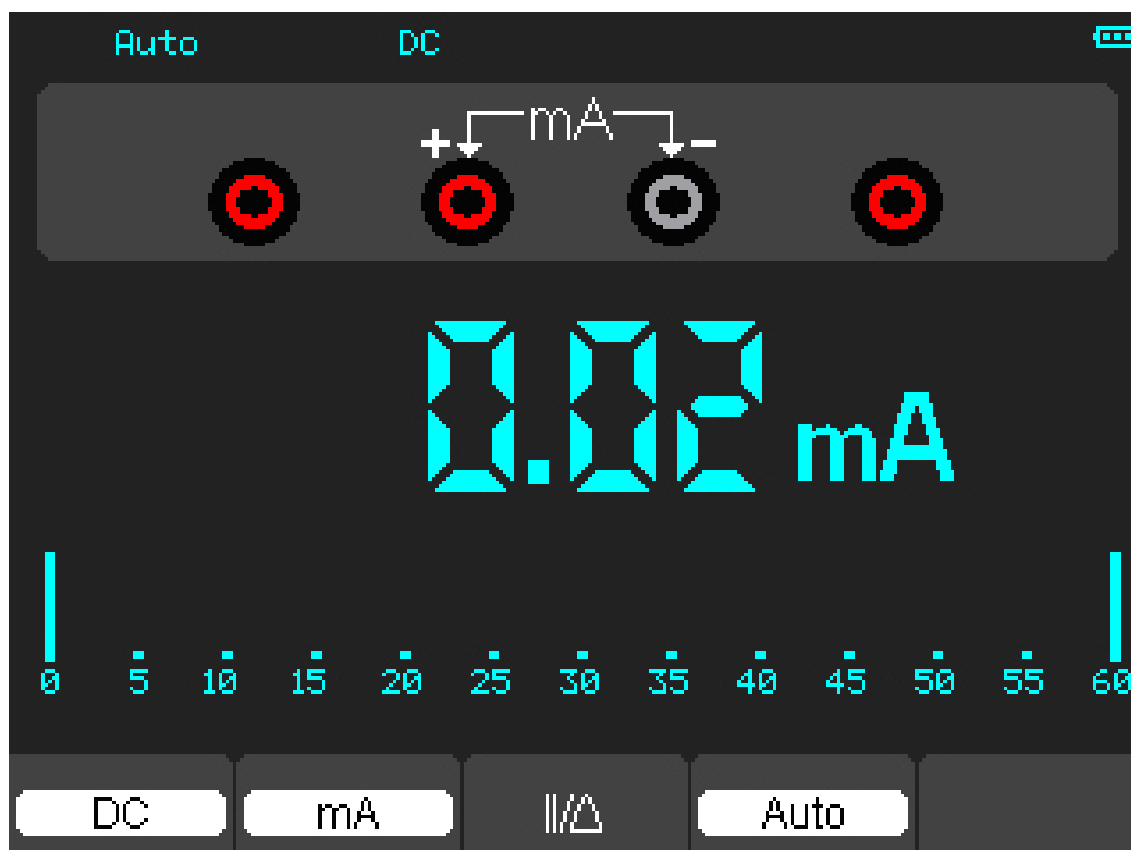
Рисунок 4-8. Измерение постоянного тока (DC) до 600мА
