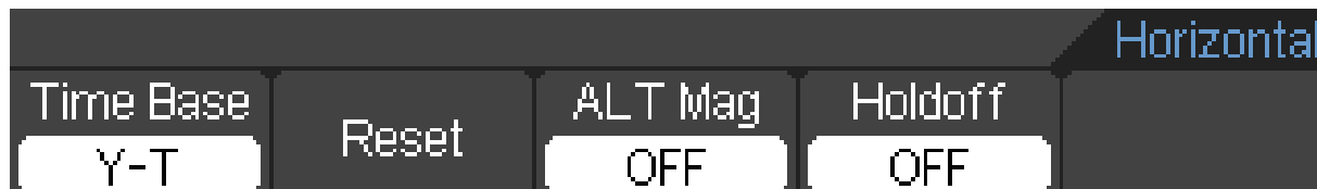
Рисунок 2-20. Меню горизонтальной развертки
