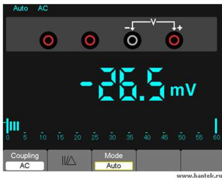
Рисунок 7-7. Измерение напряжения переменного тока
