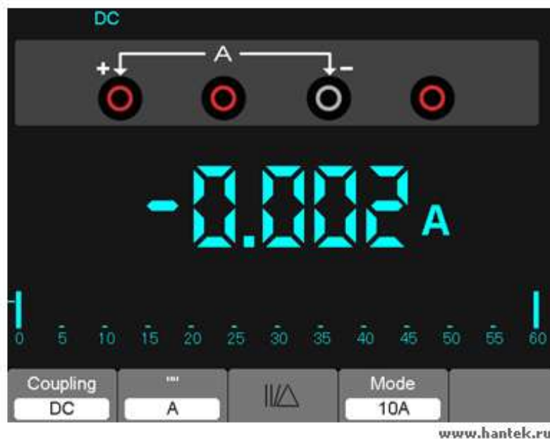
Рисунок 7-9. Измерение силы постоянного тока для 10A
