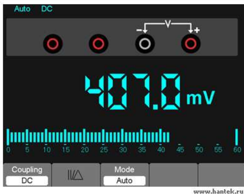
Рисунок 7-6. Измерение напряжения постоянного тока.
