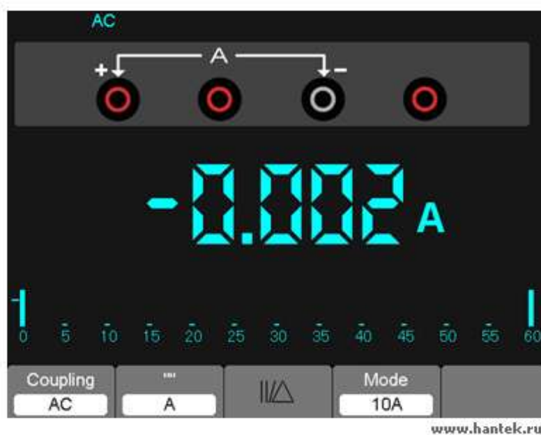
Рисунок 7-11. Измерение силы переменного тока для 10А.
