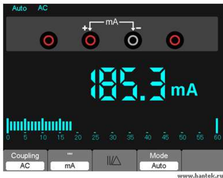
Рисунок 7-10. Измерение силы переменного тока до 600мА.
