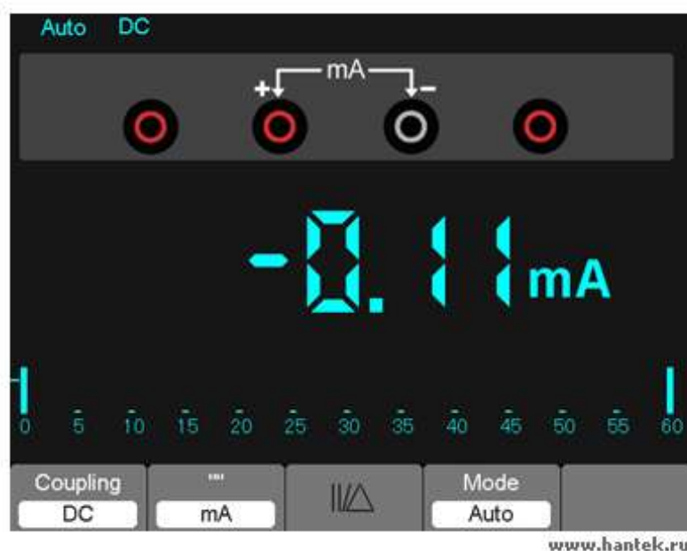
Рисунок 7-8. Измерение силы постоянного тока до 600мА.
