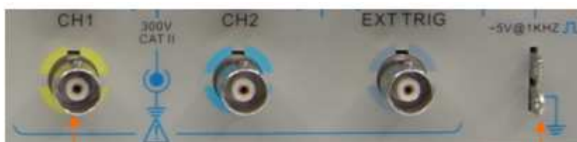
Канал 1 для подключения щупа
