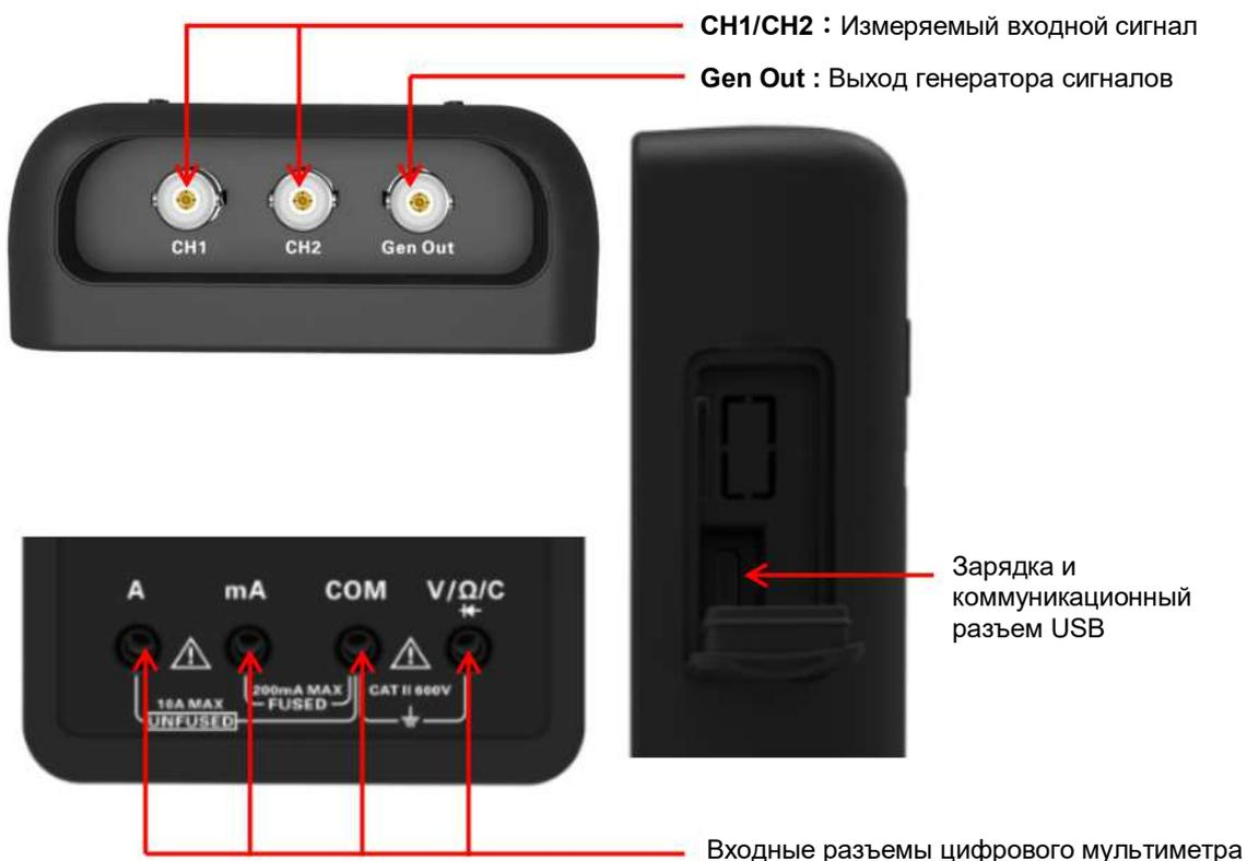
**Gen Out:** На выходе данной клеммы осциллографа без функции генератора сигналов всегда выдается прямоугольный сигнал 2 В при частоте 1 кГц.
